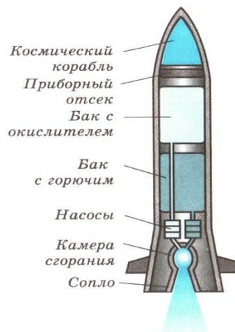
Топливо и окислитель с помощью насосов попадают в камеру сгорания. Топливо, сгорая, превращается в газ высокой температуры и высокого давления, который мощной струей устремляется наружу через раструб специальной формы, называемый соплом. Назначение сопла состоит в том, чтобы повысить скорость струи.
