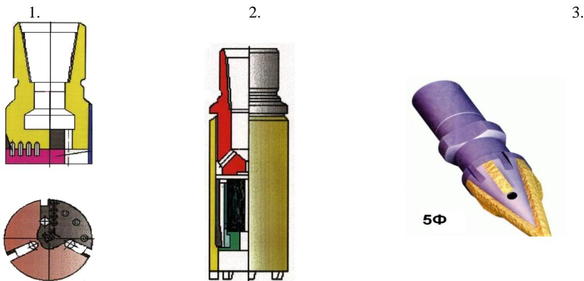
1-Торцевой фрез, 2- Магнитный фрез, 3 – Конусный
