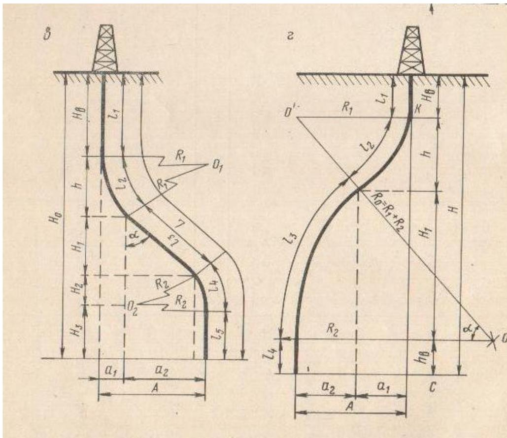
Рисунок 6 Расчетные схемы профилей
