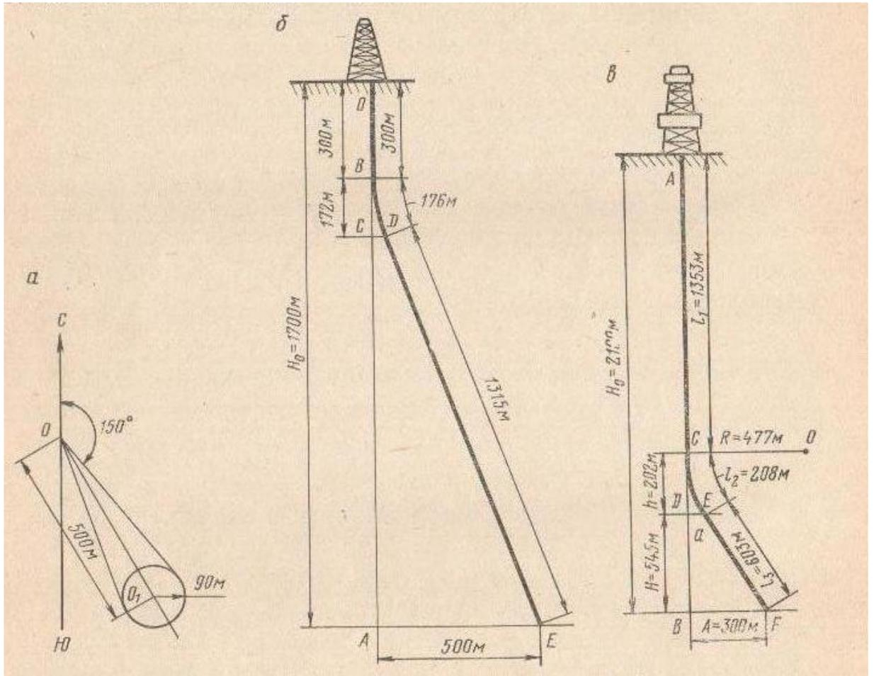
Рисунок 3 - Схема построения профиля типа А
